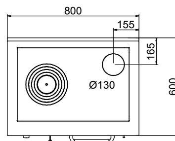
Version avec sortie de fumées à droite. La version avec sortie de fumées à gauche est symétrique.
